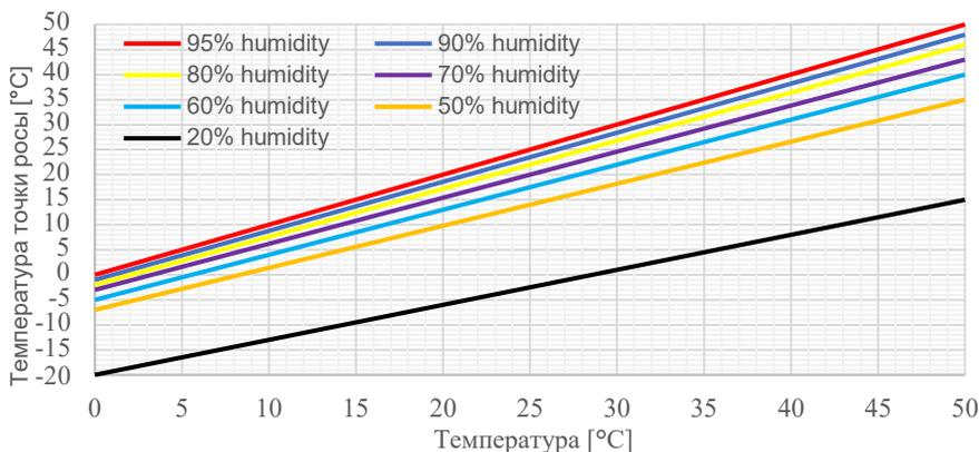
**Рисунок 7. Температура точки росы в зависимости от относительной влажности**
