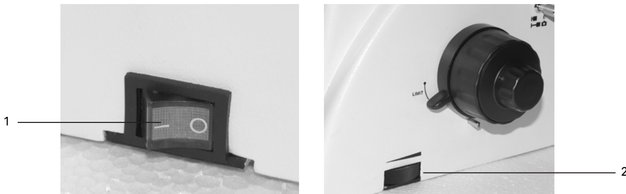
Рис. 4. Включение освещения и регулировка яркости горения лампы
