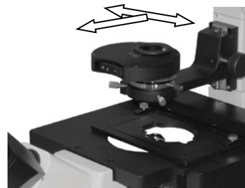
Рис. 3б. Установка конденсорного устройства
