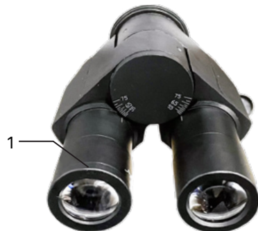
Рис. 9. Регулировка диоптрийной системы
