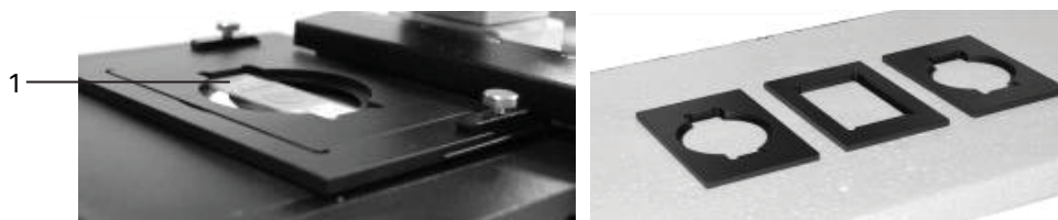
Рис. 11. Выбор и установка держателя чашки
