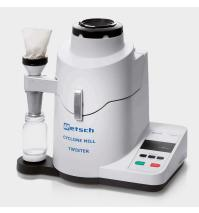
Циклонная мельница TWISTER разработана специально для подготовки проб продуктов питания и кормов для последующей ИК спектроскопии. Оптимизированная форма ротора и рабочей камеры создает поток воздуха, который переносит измельченный материал через встроенный циклон в приемную бутыль. Поток воздуха предотвращает перегрев материала и сохраняет влажность образца неизменной
